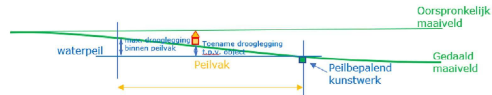
Figuur 3: Toename drooglegging doordat kunstwerk op een punt met relatief veel bodemdaling is gelegen
