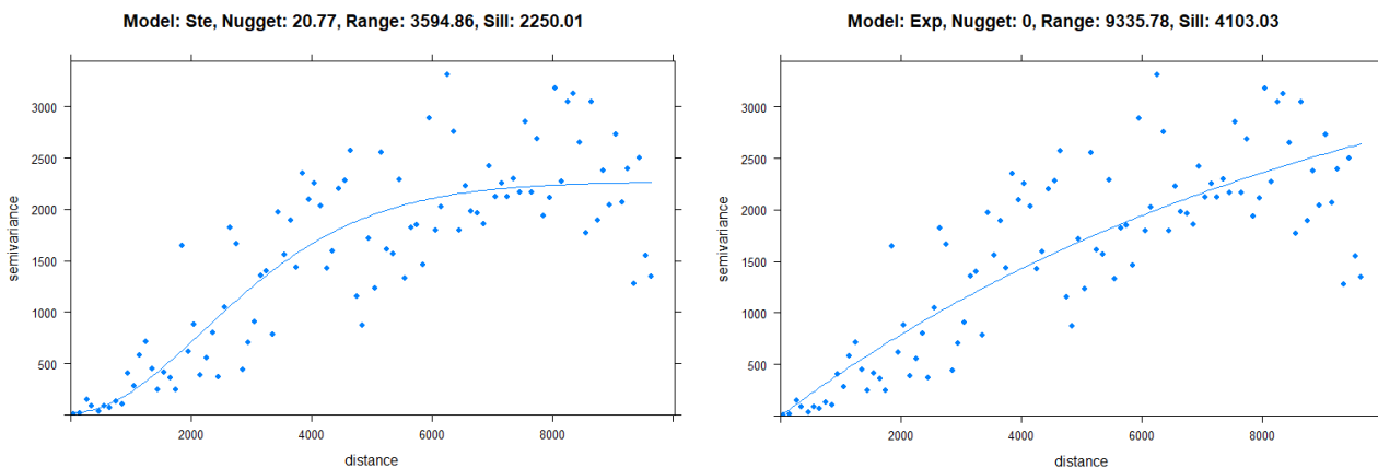
Figuur 7 Semivariogrammen voor de automatische kriging fit met Ste model (links) en Exp model (rechts)
